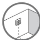
**Примечание.** Датчик температуры пола обеспечивает более точный контроль температуры. Он рекомендуется для применения со всеми системами подогрева пола и **обязателен** к применению с деревянными покрытиями пола для снижения риска их перегрева.
