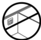
Не размещайте терморегулятор на внутренней стороне наружной стены.
