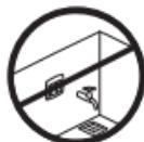
Не следует устанавливать терморегулятор в помещениях с повышенной влажностью. В таком случае следует разместить его в соседнем помещении. При установке терморегулятора соблюдайте местные нормы по IP-классам защиты.
